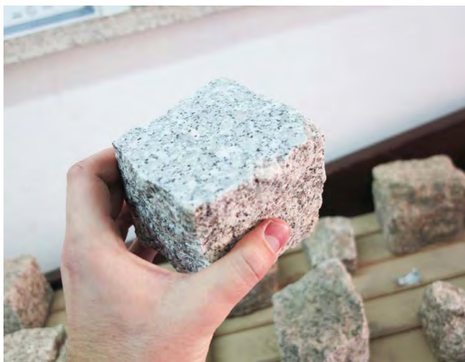
žulová kostka s řezanou horní hranou
