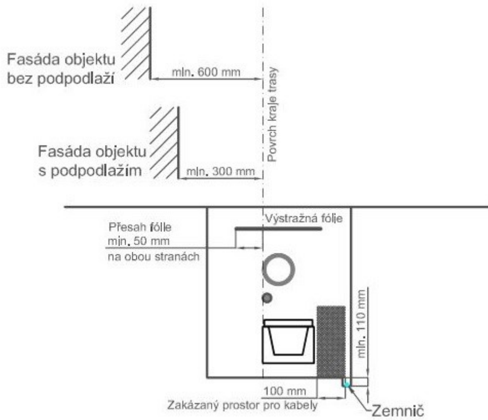
Obrázek 6 Společná pravidla pro uložení kabelů
