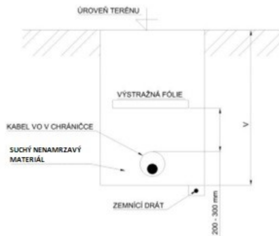
Obrázek 7 Vzorové řezy uložení kabelů
