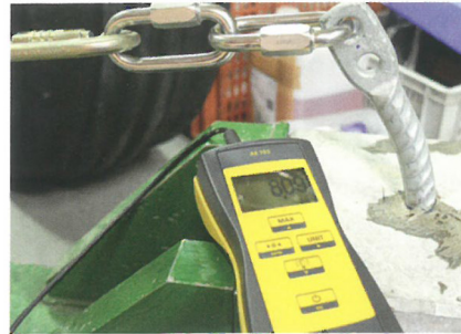
Tabulka 2: Deformace ohybem na kotvě (elastická a plastická); \varnothing = 16 mm, l = 220 mm
