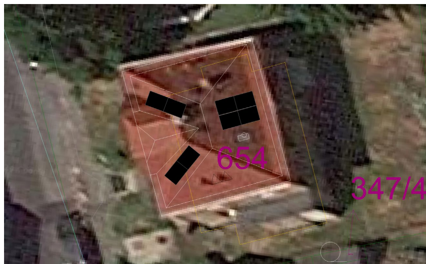
Obrázek 6. Situace rozložení 8 ks panelů.
