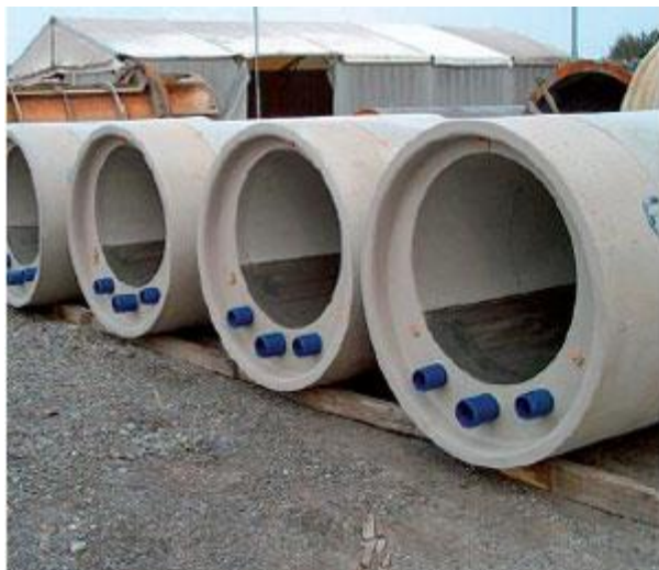
Obr. 10 Tepelný výměník integrovaný v gravitačním potrubí [16]
